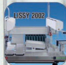
Robot de pipetage LISSY 2002 à deux bras
